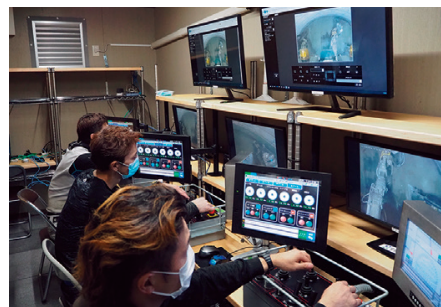
中央制御室における穿孔作業の遠隔操作状況
