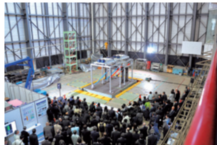
座屈拘束ブレースの振動実験の様子
