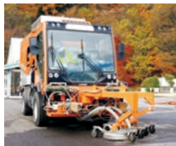
写真①: アライグマラジカル工法の施工機械
