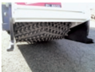
写真②: アスファルト舗装薄層切削工法用切削機
