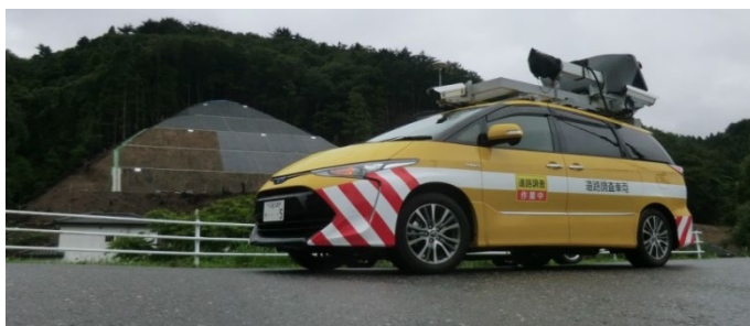
モバイル・マッピング・システムによる工事現場の計測
