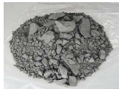
路盤材（破碎材）
