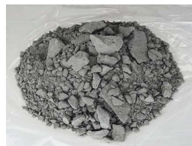
路盤材（破碎材）
