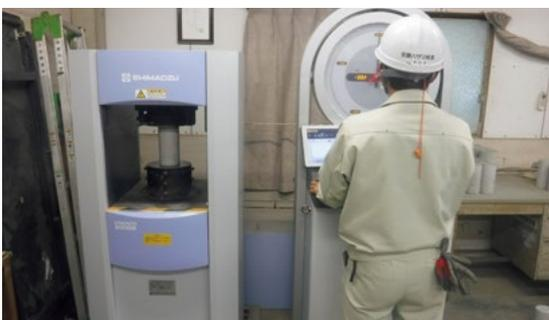
打設したコンクリートの強度をテストピースで確認
