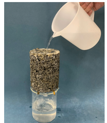
透水性改良体 透水係数 k=1.0 \times 10^{-3} \text{m/sec} 一軸圧縮強度 q_u=5.0 \text{MPa}
