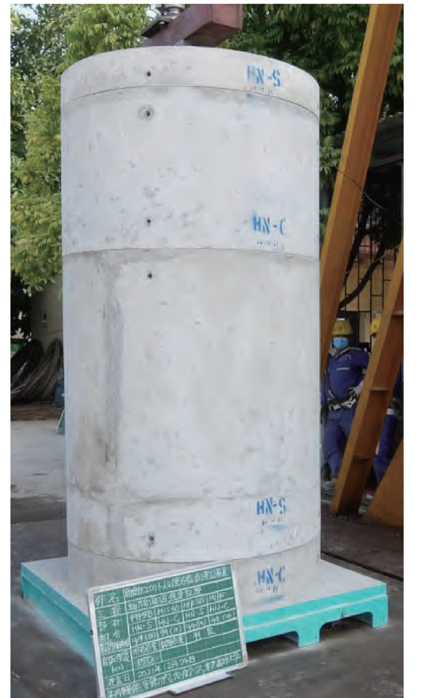
軸方向耐圧試験状況（ベトナムでの試験）
