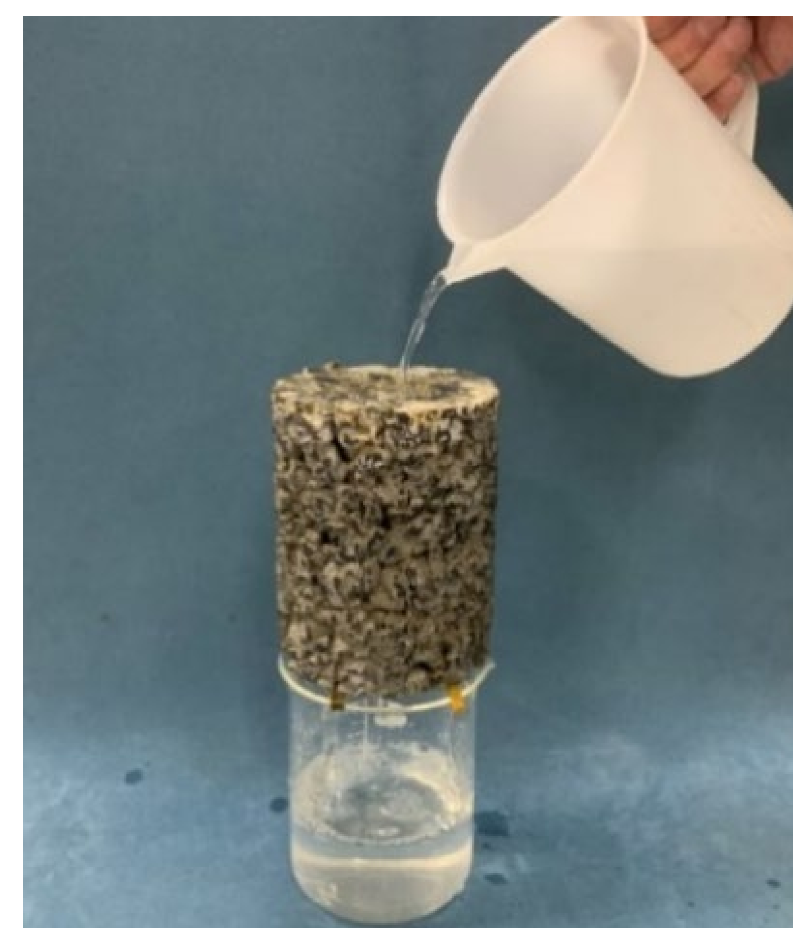
透水性改良体 透水係数 k=1.0 \times 10^{-3} \text{m/sec}
