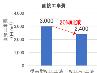
WILL-m工法の適用効果 (粘性土5,000m³程度以上)
