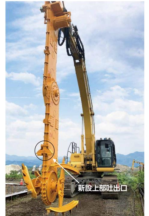
WILL-m工法施工機械全景
