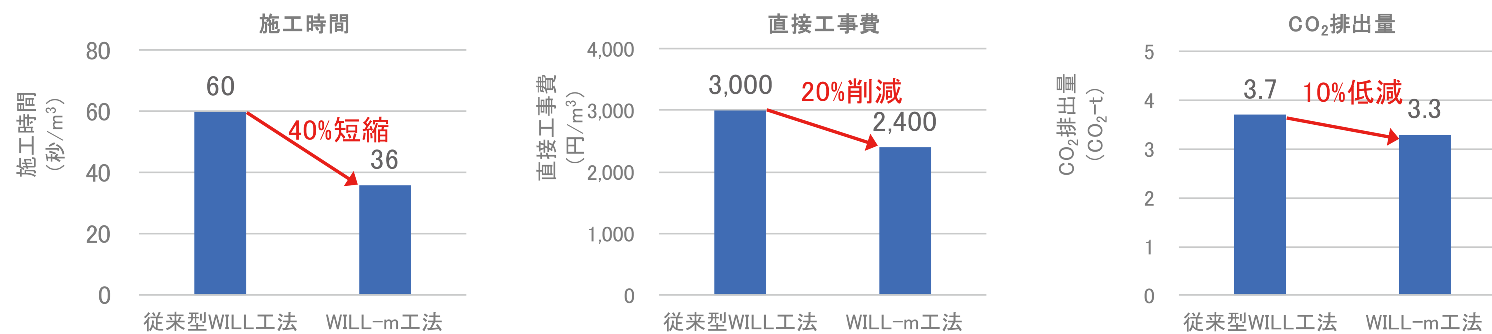
WILL-m工法の適用効果(粘性土5,000m³程度以上)
