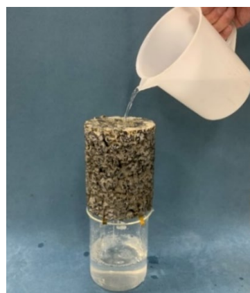
透水性地盤改良体
