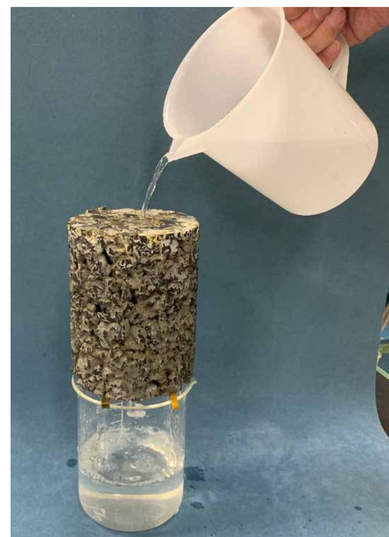
透水性地盤改良体 透水係数 k=1.0 \times 10^{-3} \text{m/sec}
