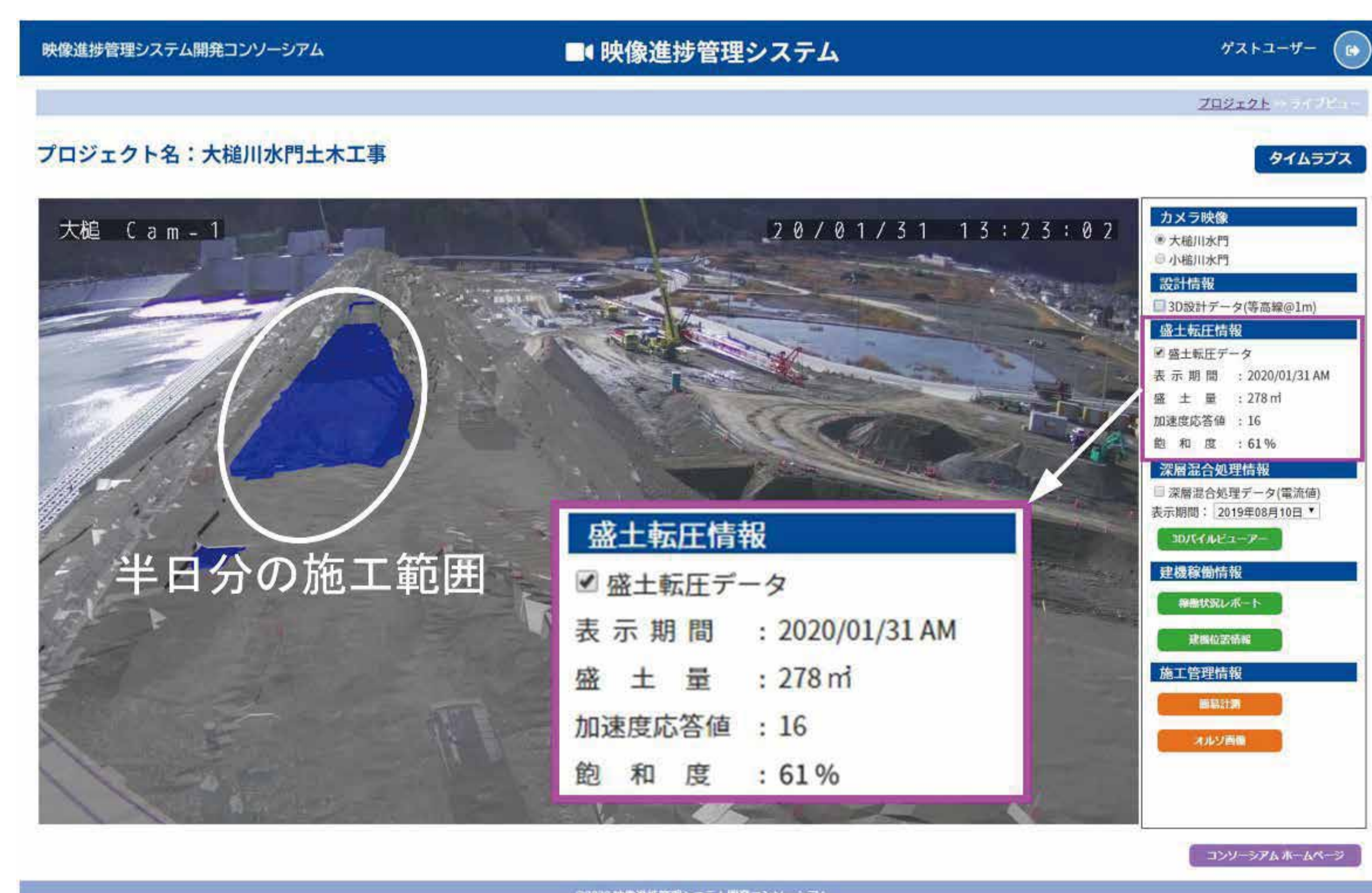
振動ローラのGNSSデータの重畳表示
