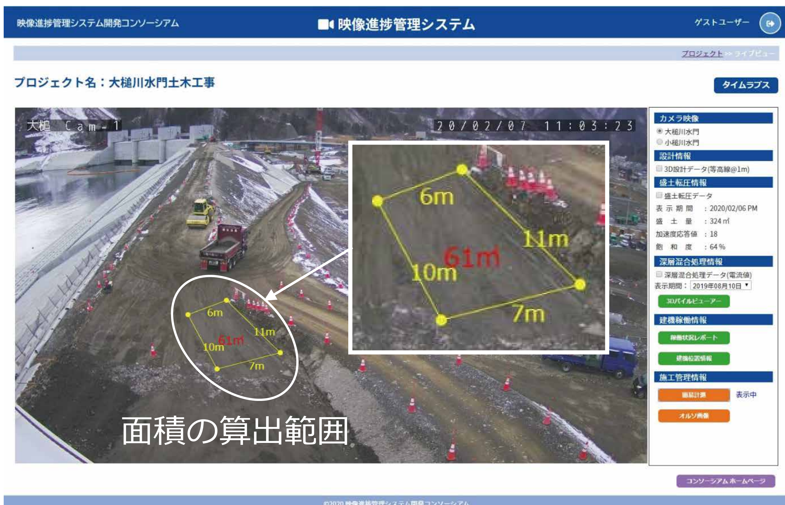
資材ヤードの面積計測
